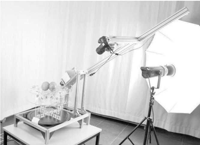
Im Anschluss wertet AICON 3D-Studio, eine Photogrammetrie-Software und die einzige kommerzielle Software im beschriebenen Digitalisierungsverfahren, die mit einer Nikon D-600 erzeugten Fotos aus und fertigt ein Protokoll an, in dem ebenfalls die Koordinaten der Referenzmarken vermerkt werden.<sup>15</sup>
