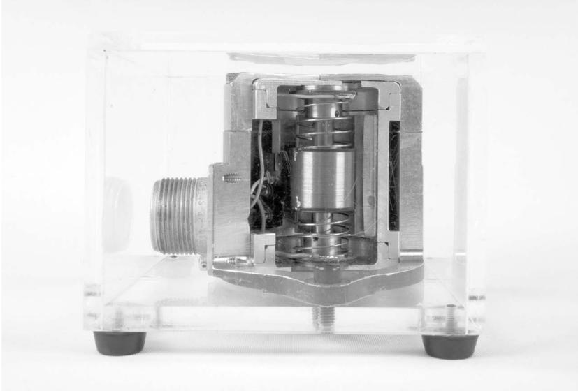
In der Fotografie (Abb. 3) sowie im 3D-Digitalisat (Abb. 4) sind zahlreiche Details zu erkennen, u.a. die grünen und roten Kabel, die für das Instrument konstruktiv wichtig sind, da sie die Signalübertragung der gemessenen Beschleunigung verantworten. Diese Kabel sind im 3D-Modell (Abb. 5) nicht modelliert und damit auch nicht vorhanden. Ein wichtiges Detail des Originals wurde also nicht mit aufgenommen.
