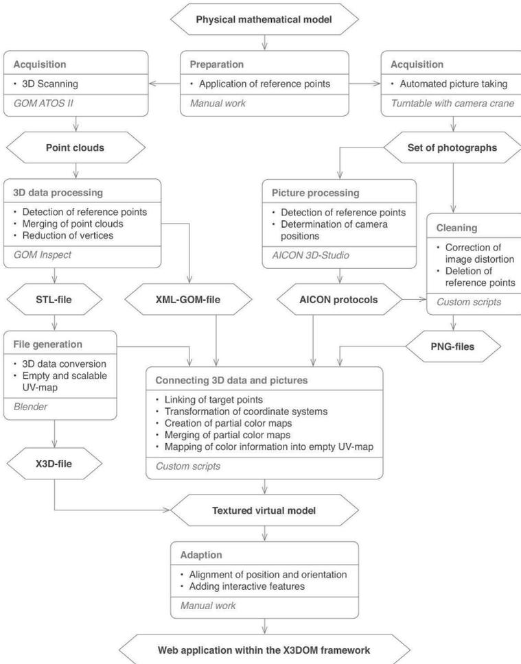
können dann anschließend mit CAD-Software, zum Beispiel Blender, nachmodellierend hinzugefügt werden. DAMM bindet solche Hybride aus gescannten und programmierten Daten ein. Auch hier werden X3D-Dateien mit PNG-Grafiken verknüpft.
